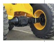
Robuste, kräftig dimensionierte Achsen und sichere Scheibenbremsen
