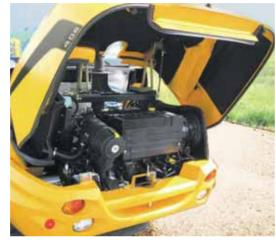
Der kraftvolle 4-Zylinder mit 3,6 Liter Hubraum und 46 kW/62 PS besitzt ein hohes Durchzugsvermögen, ist aber gleichzeitig sehr sparsam im Kraftstoffverbrauch.
