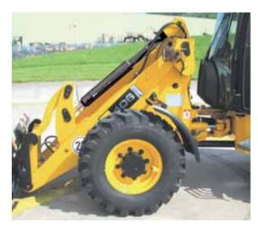
Das Hubgerüst mit Parallel-Kinematik erreicht eine Überladehöhe von fast 3 m und bietet eine exakte Parallelführung über den gesamten Hubbereich.
